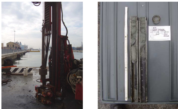
Figura 10: Esecuzione della prova SPT e campionatore Raymond
