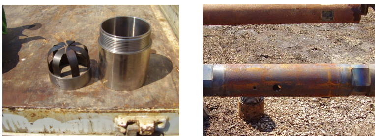
Fig. 8: Cestello per catturare i terreni particolarmente sciolti e valvola in testa al carotiere.
